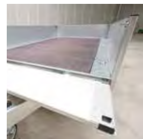
Eloxierte Aluminium-Bordwände vierseitig abklapp- und abnehmbar
